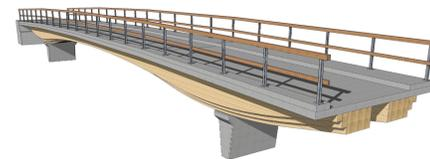
Referenzobjekt Brücke in Holz- Beton- Verbundbauweise
