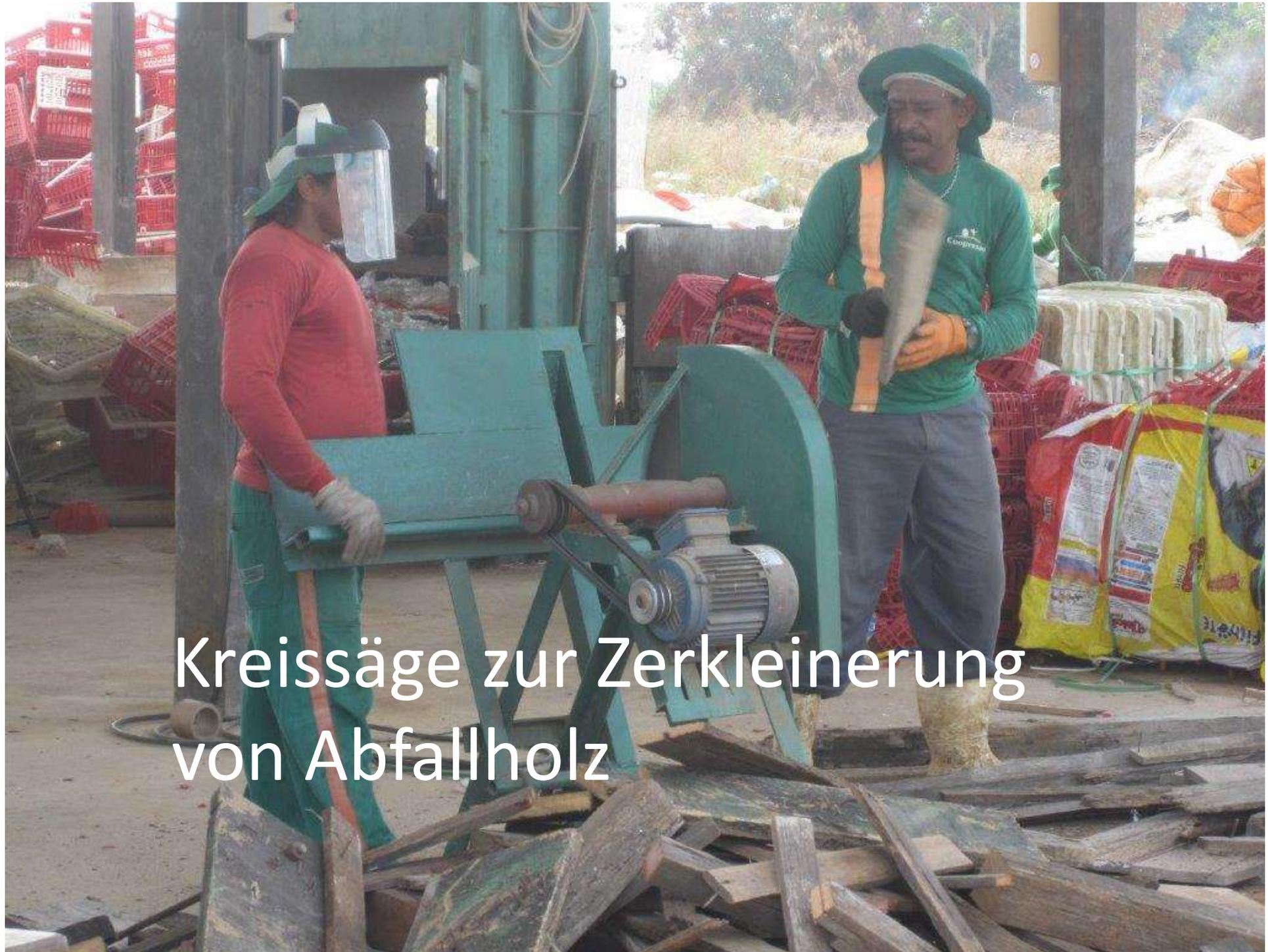
Kreissäge zur Zerkleinerung
